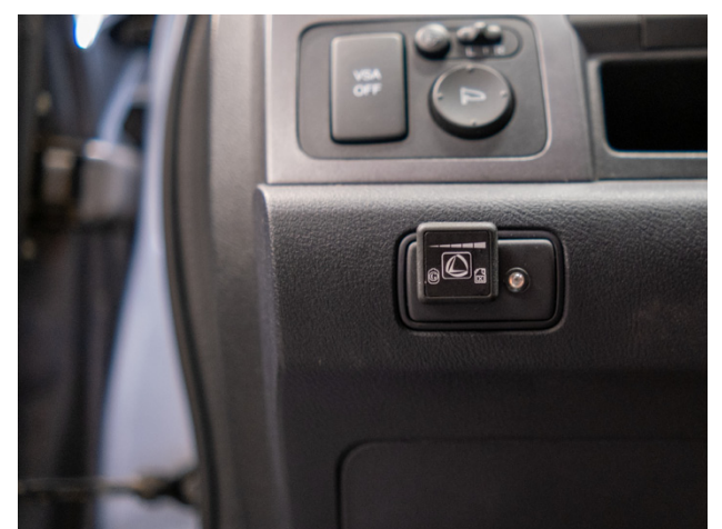
Vid en konvertering installerar en liten ledpanel som visar hur mycket gas som finns kvar i tanken.
