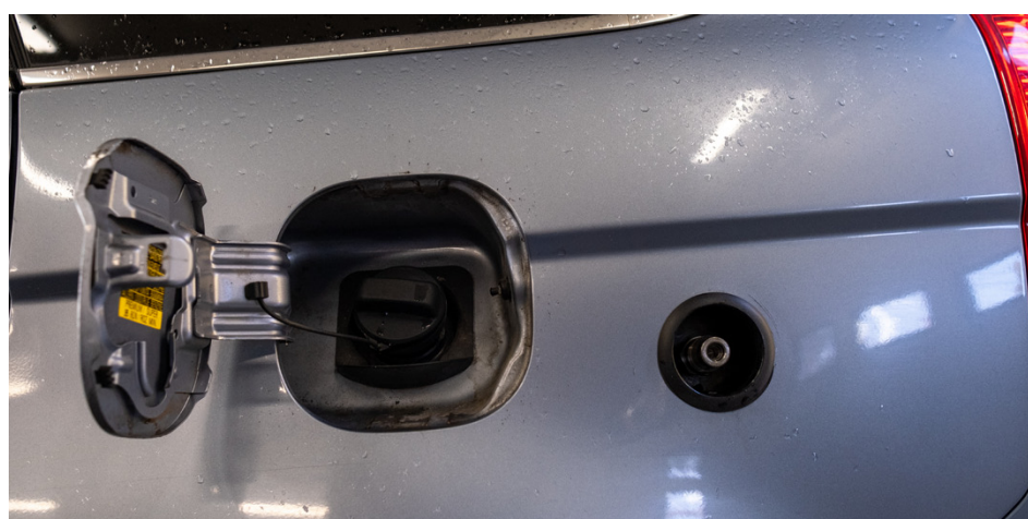
När man konverterar en bil så försvinner inte bensintanken. Man kan fortsättningsvis köra på båda drivmedlen.
